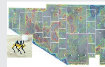
로봇 활용 콘크리트 슬래브 평탄성 평가
